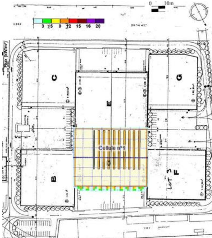
Figure 5. Simulation des flux thermiques en cas d'incendie généralisé de la cellule D
